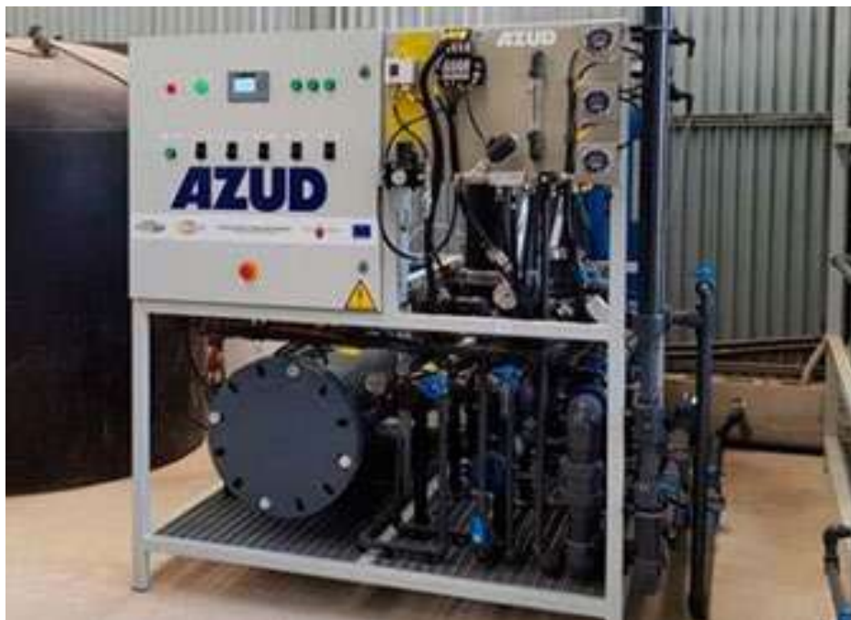
Equipo piloto para el estudio de la regeneración de aguas residuales tratadas
