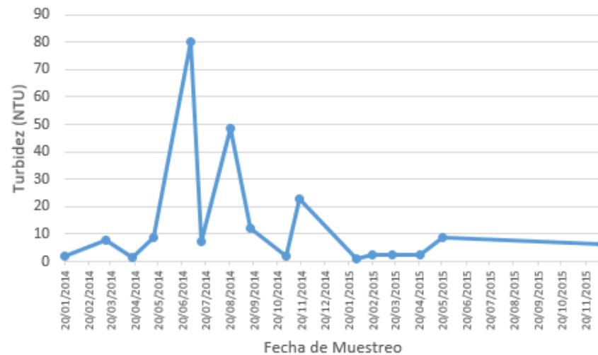
O gráfico à esquerda mostra as flutuações na turbidez da água de rio na captação em uma planta de Clarificação Convencional no Sul da Argentina.
